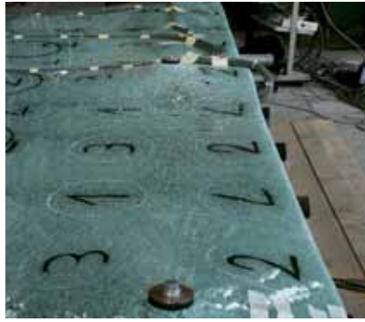
Fig. 6.16 - Particolare della lastra temperata termicamente collassata
