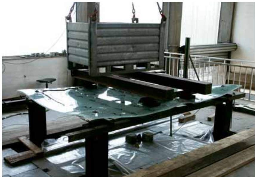
Fig. 6.14 - Collasso della lastra di vetro temperato termicamente
