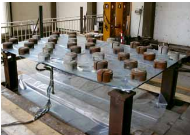
Fig. 6.8 - Posizionamento della lastra e carico
