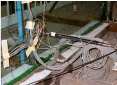
Fig. 6.3 - Applicazione degli estensimetri alla lastra temperata chimicamente
