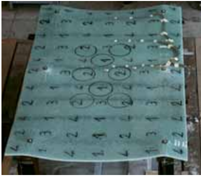
Fig. 6.15 - Modalità di collasso della lastra temperata termicamente
